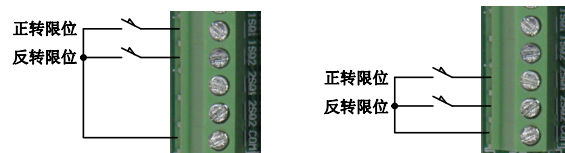
图 2.14 模块 1 限位开关的接法（图左）/模块 2 限位开关的接法（图右）
