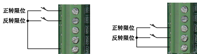
图 2.9 模块 1（图左）/模块 2（图右）机械限位开关的接法
